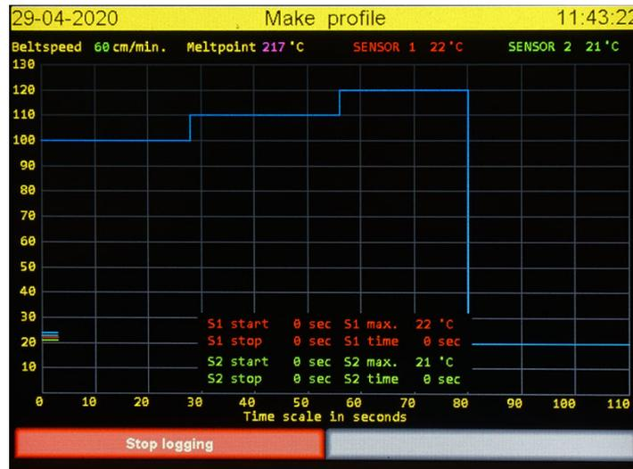
3. Une fois que le bouton **Démarrage de l'enregistrement** est remplacé par deux autres boutons, **Effacer écran** et **Enregistrer données journal**, vous pouvez retirer le produit de la bande et déconnecter le(s) capteur(s).
