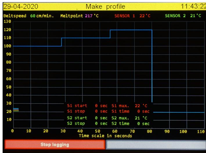
3. Wird statt der Schaltfläche **Stop logging** (Aufzeichnung beenden) die Schaltfläche **Clear screen** (Anzeige löschen) und **Save log data** (Aufzeichnungsdaten speichern) angezeigt, können Sie das Produkt vom Gurt nehmen und den oder die Sensoren abklemmen.
