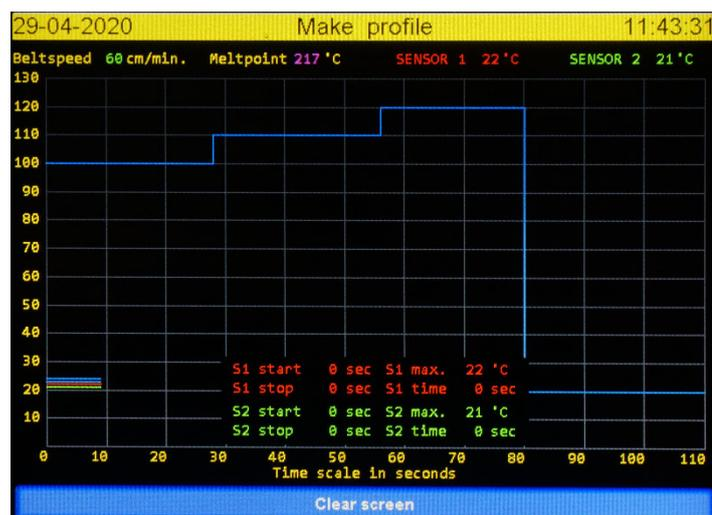
Mit **Clear screen** (Anzeige löschen) kehren Sie zur Profilsansicht zurück.
