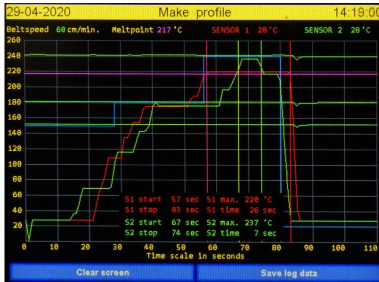
**Bemerkung:** Die Schaltfläche **Save log data** (Aufzeichnungsdaten speichern) ist nur bei angeschlossenem USB-Stick vorhanden. Ansonsten wird die Schaltfläche **Clear screen** (Anzeige löschen) angezeigt.
